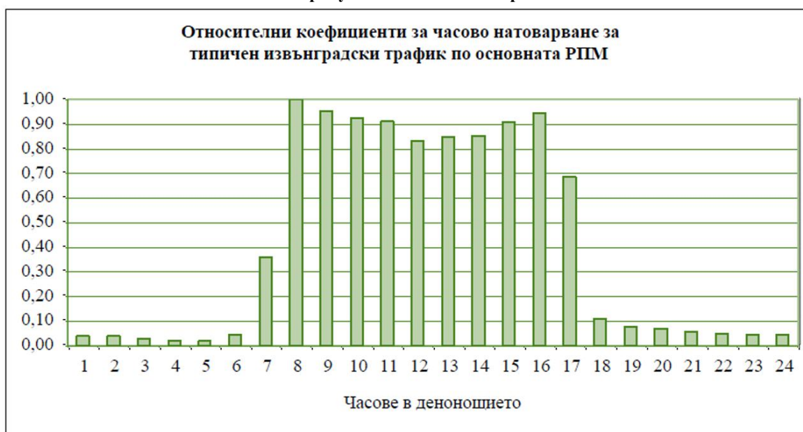
Фиг. 4 Относителни коефициенти на часово натоварване на типичен извънградски трафик по основната републиканска пътна мрежа
